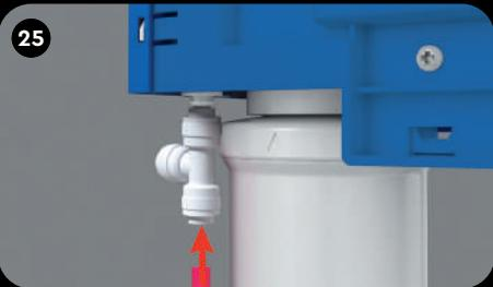
25 Вставьте фитинг-тройник в фитинг блока фильтра, где написано TANK, затем вставьте свободный конец красной пластиковой трубы в фитинг-тройник снизу.
