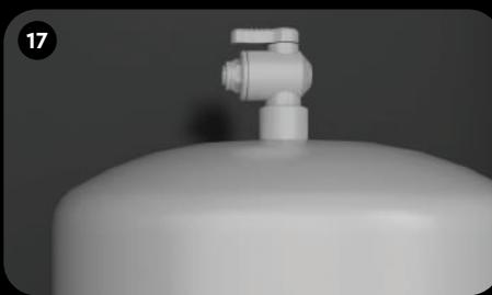
Установите кран на накопительную емкость. Оберните резьбу двумя-тремя слоями ленты ФУМ (приобретается отдельно) для герметизации. Рукой заверните кран до упора.
